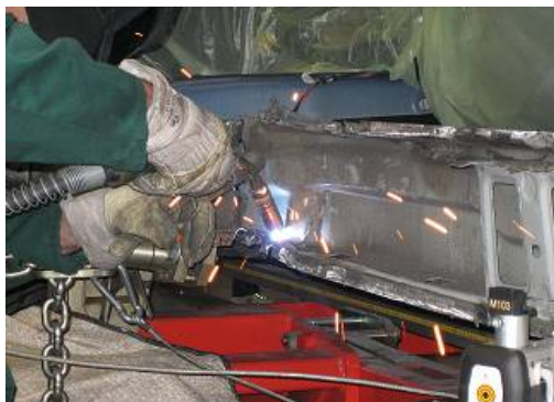
Bild 6: MAG-Schweißungen am Schwellerverstärkungsblech
