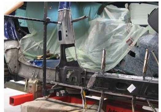
Bild 7: Anpassen der teilersetzten B-Säulenbindung
