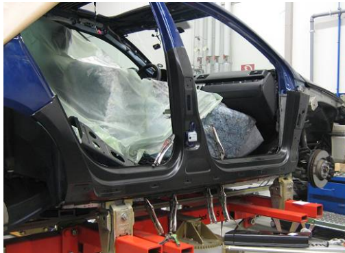
Bild 8: Anpassung des Seitenrahmens
